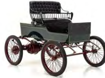
1901, Pope-Waverley Electric, due posti, motore da 2,2 kW con 30 batterie
