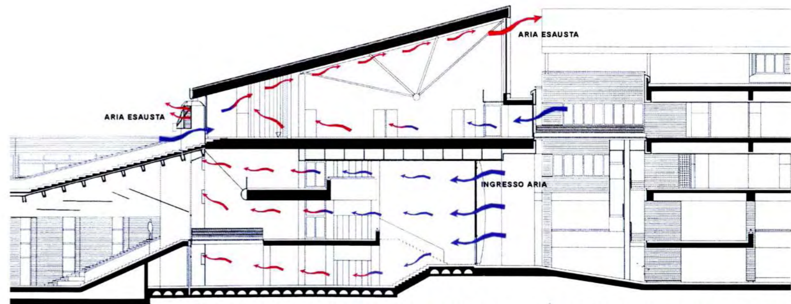
CENTURIATIO - SCHEMA DELLA VENTILAZIONE NATURALE
