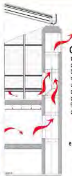
SEZIONE TRINO PIANO SCHEMA DI VENTILAZIONE NATURALE
